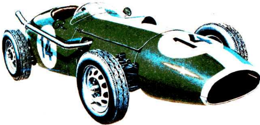
Гоночный автомобиль ГА-22 с карданным валом, расположенным справа от гонщика. 1958 г.
