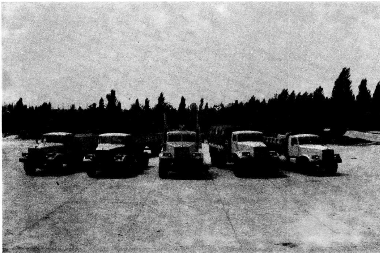
Унифицированное семейство автомобилей КраЗ. Справа налево модели: 256Б, 255Б, 255Л, 258 и 257 образца 1966—1968 гг.
