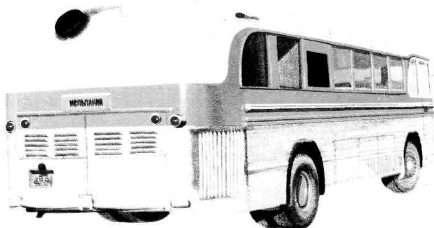
Газотурбинный автобус «Турбо НАМИ-053». 1959 г.
