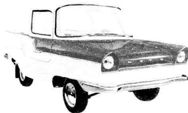
Автомобиль МВТУ с кузовом из стеклопластика. 1958 г.
