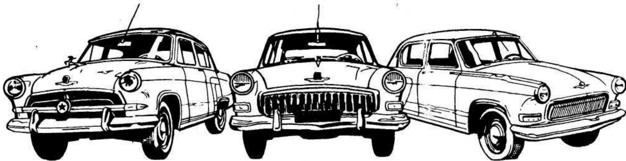
Серийные автомобили ГАЗ-21 с различными облицовками радиаторов (слева направо): ГАЗ-21Б (1956 г.), ГАЗ-21И (1958 г.), ГАЗ-21Л (1962 г.)
