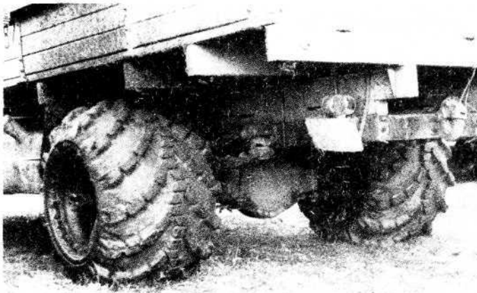
Арочные шины на заднем мосту автомобиля ЗИС-150. 1957 г.
