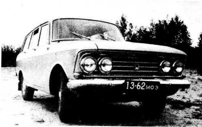
«Москвич-426» с четырехфарной системой освещения. 1967 г.
