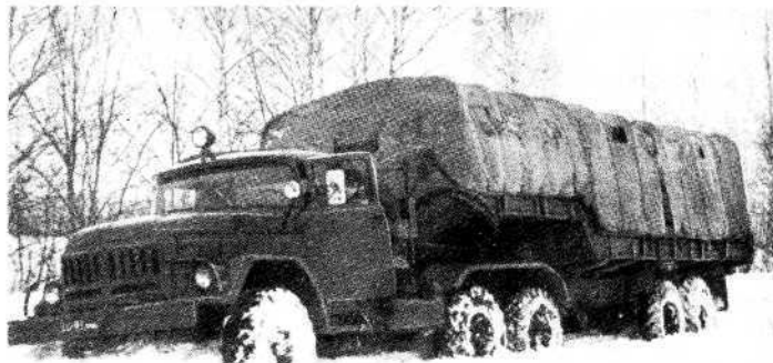
ЗИЛ-137 с активным полуприцепом ЗИЛ-137Б. 1971 г.
